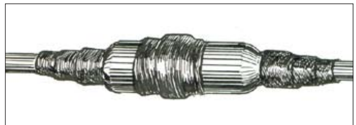
Рис. 4.5. Все три стыка муфты обмотаны лентой ЛГ-2
