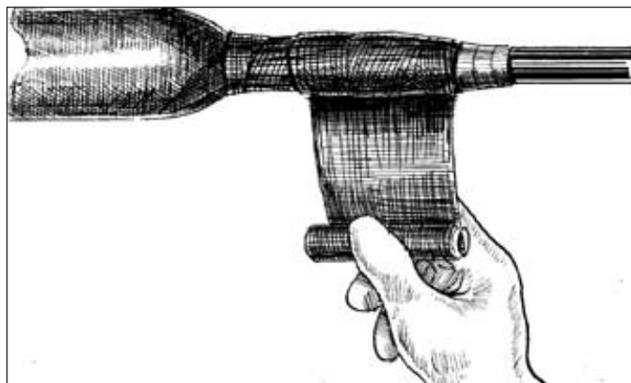
Рис. 4.16. Наложение бинта «Армопласт» на стык свинцовой втулки с полиэтиленовой оболочкой кабеля ТППЭп
