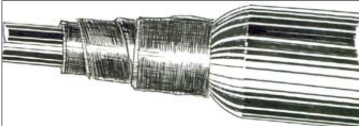
Рис. 4.2. Конус муфты с намотанной лентой ЛГ-2
