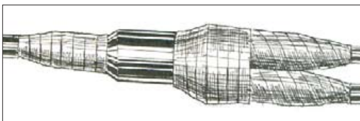
Рис. 4.12. Разветвительная муфта. Стыки обмотаны лентой ЛГ-2 и лентой 88Т
